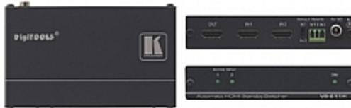
VS-211H ist ein Hochleistungs-Automatik-Umschalter für HDMI-Signale. Wenn als Standby-Umschalter konfiguriert schaltet er automatisch auf den Sekundär-Eingang, wenn das Signal am Primär-Eingang ausfällt. Wenn das Signal am Primär-Eingang wieder verfügbar ist, schaltet der VS-211H automatisch auf diesen zurück.
